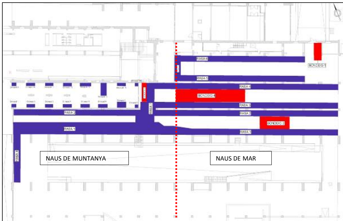
Distribució de les rases d'obra (en color blau) i dels sondejos arqueològics (en color vermell), efectuats a les tres naus nord de l'edifici principal de les drassanes. Intervenció 057/11.
